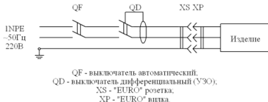
Рис. 1. Схема подключения изделия к электросети
